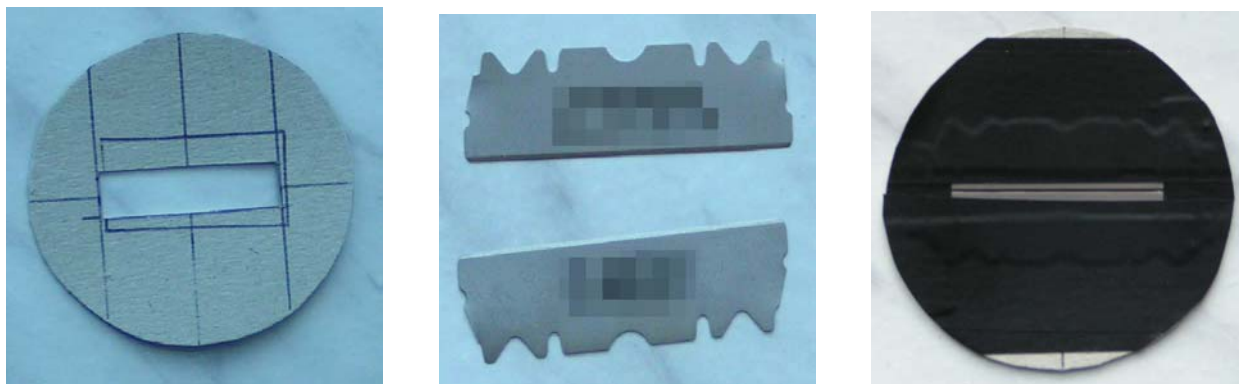
Rys. 5: Elementy szczeliny i gotowa szczelina żyletkowa
